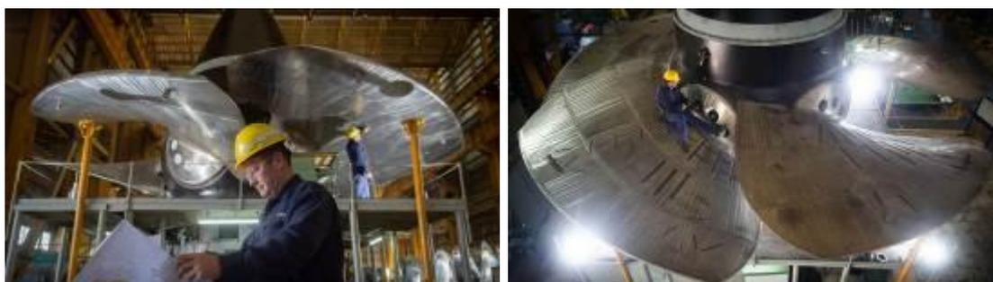
Questa turbina Kaplan, di 155 MW, è stata disegnata con altissima tecnologia e programmi di intelligenza artificiale e fabbricata da IMPSA nel suo Centro di Sviluppo Tecnologico a Mendoza, e permetterà ad oltre 270.000 famiglie di avere energia elettrica.
